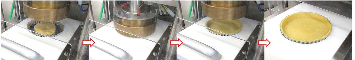
生地を載せたカップを押込み、プレス成形し、引き出すと、成形カップの完成です
