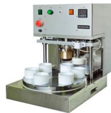
ターンテーブル式 タルト成形機
